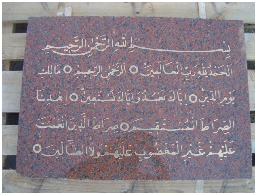
Обр.4 Надгробен паметник върху гранит на арабски език, изработен с технологията на пясъкоструйката(по: автора)
