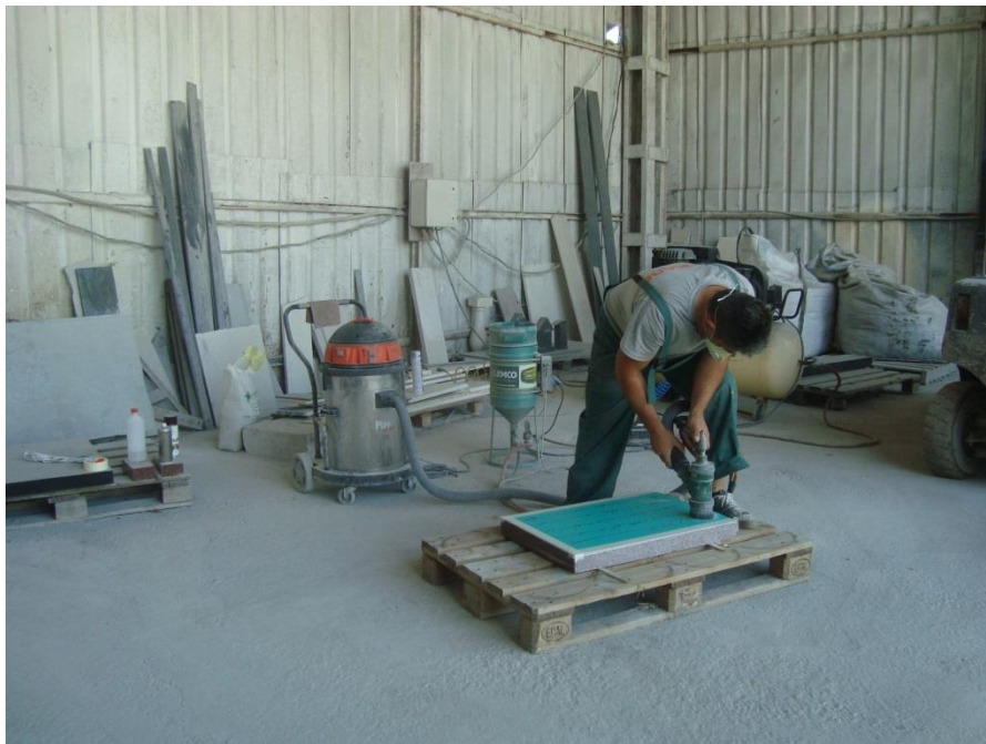
Обр.11 Изработване на паметник с пясъкоструйка (по: автора)
